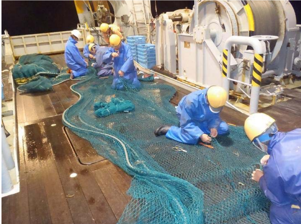
破網箇所修理
