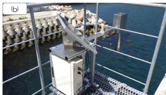
図1 移動型電波式験潮器の外観
