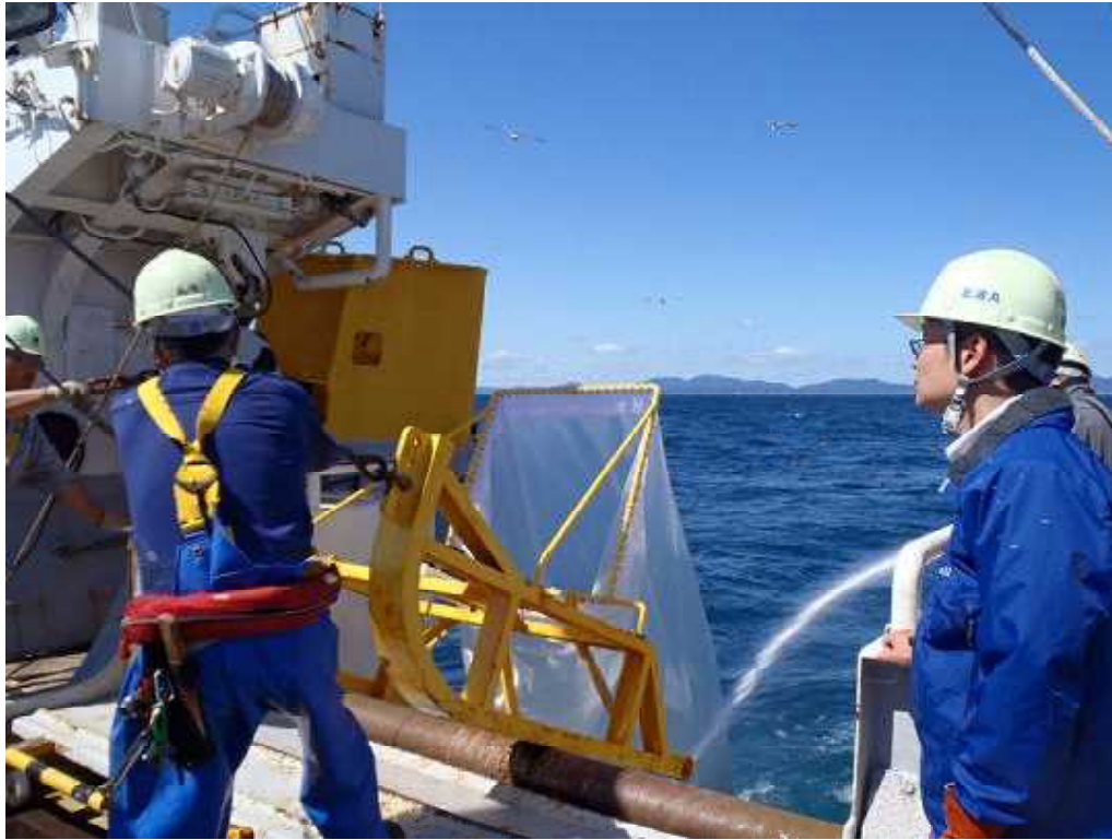
ソリネットによる動物プランクトン採集作業
