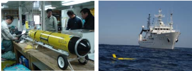
写真1. 左：水中グライダー（海中での水温、塩分、溶存酸素、クロロフィル濃度を観測） 右：潜行直前の水中グライダーと調査船「若鷹丸」
