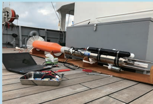
図2：海水の混合強度を測定する鉛直微細構造観測器（通称：乱流計）
