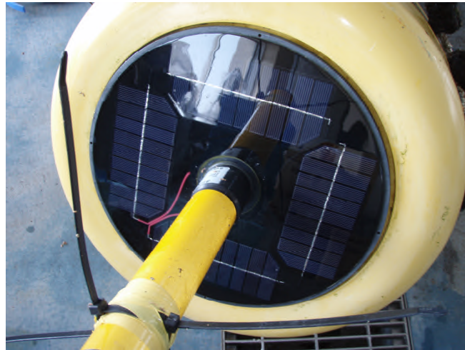
太陽電池パネル部
