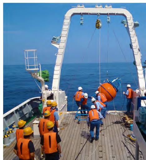
図2. 学術研究船（淡青丸）を利用した、大槌湾沖での大型 ADCP 係留観測の様子。
