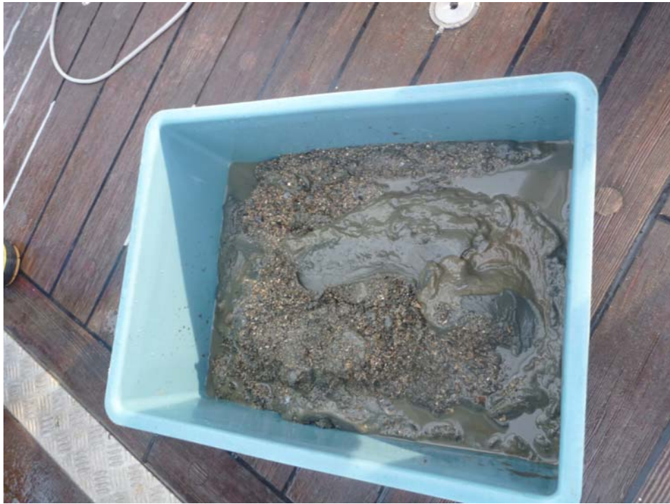
図4. スミスマッキンタイヤ採泥器で採集した海底土。下層が粒径の大きい砂で構成されているのに対し、表層は粒径の細かい泥で構成されていた。
