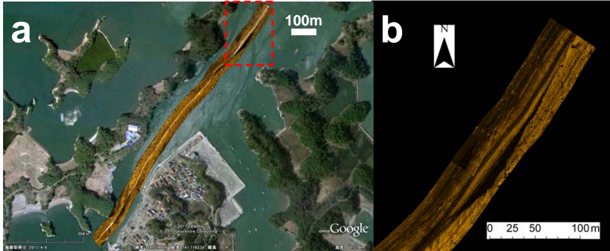
Fig. 10 a. Area C のサイドスキャンソナー画像モザイク図と空中写真（撮影日：2011年4月6日。出典：Google Earth）との合成図。b. Fig. 10a の赤破線枠内の拡大図。細長い紡錘形の影の長さは187 m（Nagao et al. 投稿中）。
